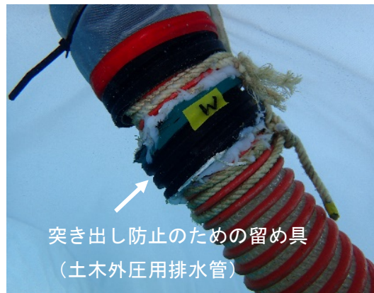
図-I.2.24 ホース突き出し防止策
