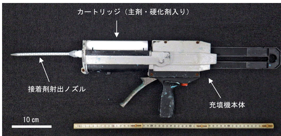
図Ⅱ.2-22 ガン式接着剤充填機
