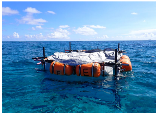
幼生収集装置の設置状況（水面部）
