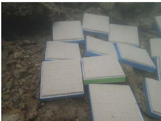
礫の上に置いて浸漬した角柱型着床具
