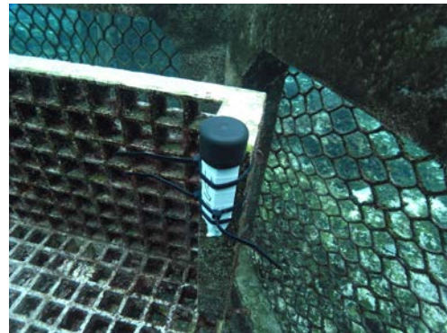
図Ⅱ.2-49 メモリ式水温計の設置
