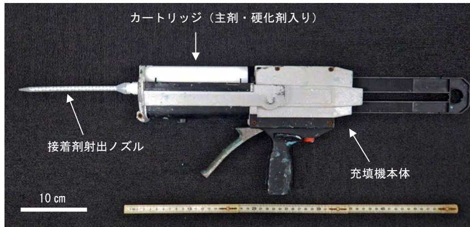
図Ⅱ.2-47 ガン式接着剤充填機
