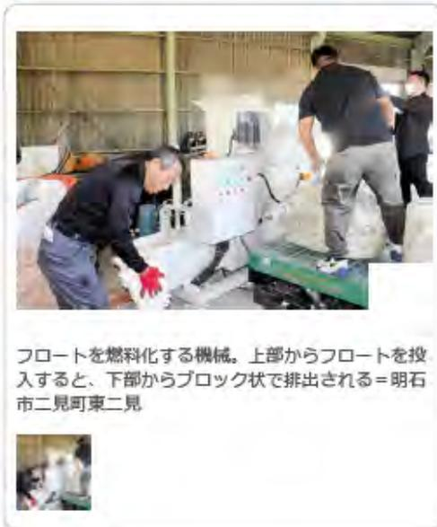
フロートを燃料化する機械。上部からフロートを投入すると、下部からブロック状で排出される=明石市二見町東二見
