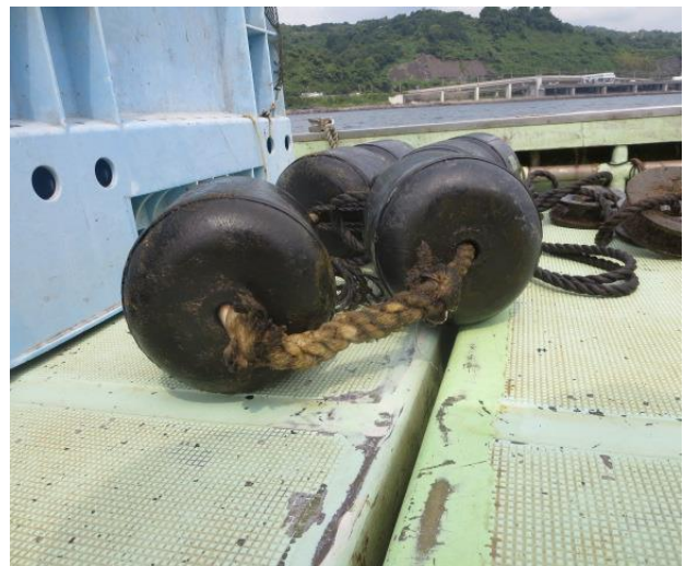
図 2-1-6 これまで変形が激しかった先端部の様子
