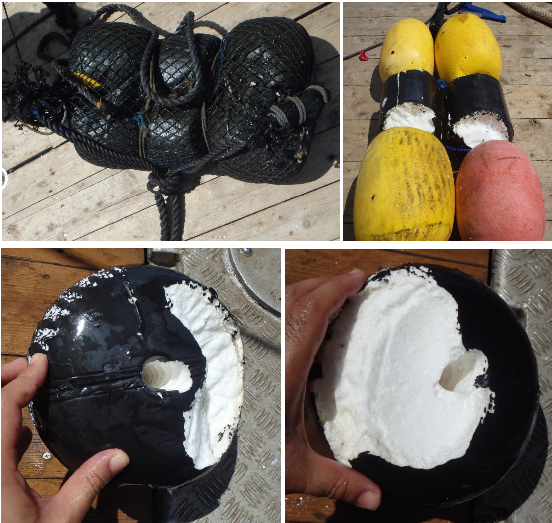
図2-1-9 令和4年放流分(漂移日数322日)のPLAフロートの破損状況
