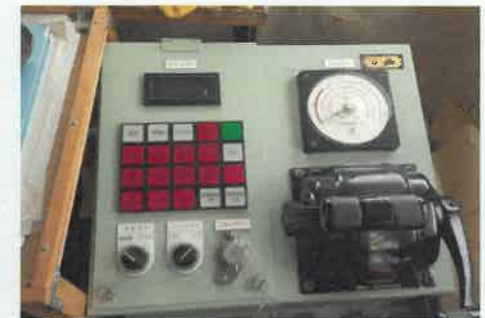
ブリッジ内機関制御盤 (機関回転計、緊急停止ボタン、 排気温度計、主機制御レバー、ギア切替、各種警報等)
