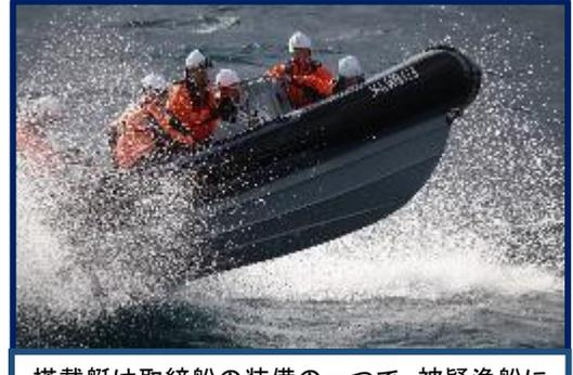
搭載艇は取締船の装備の一つで、被疑漁船に移乗(乗り移る)際に使用されます。
